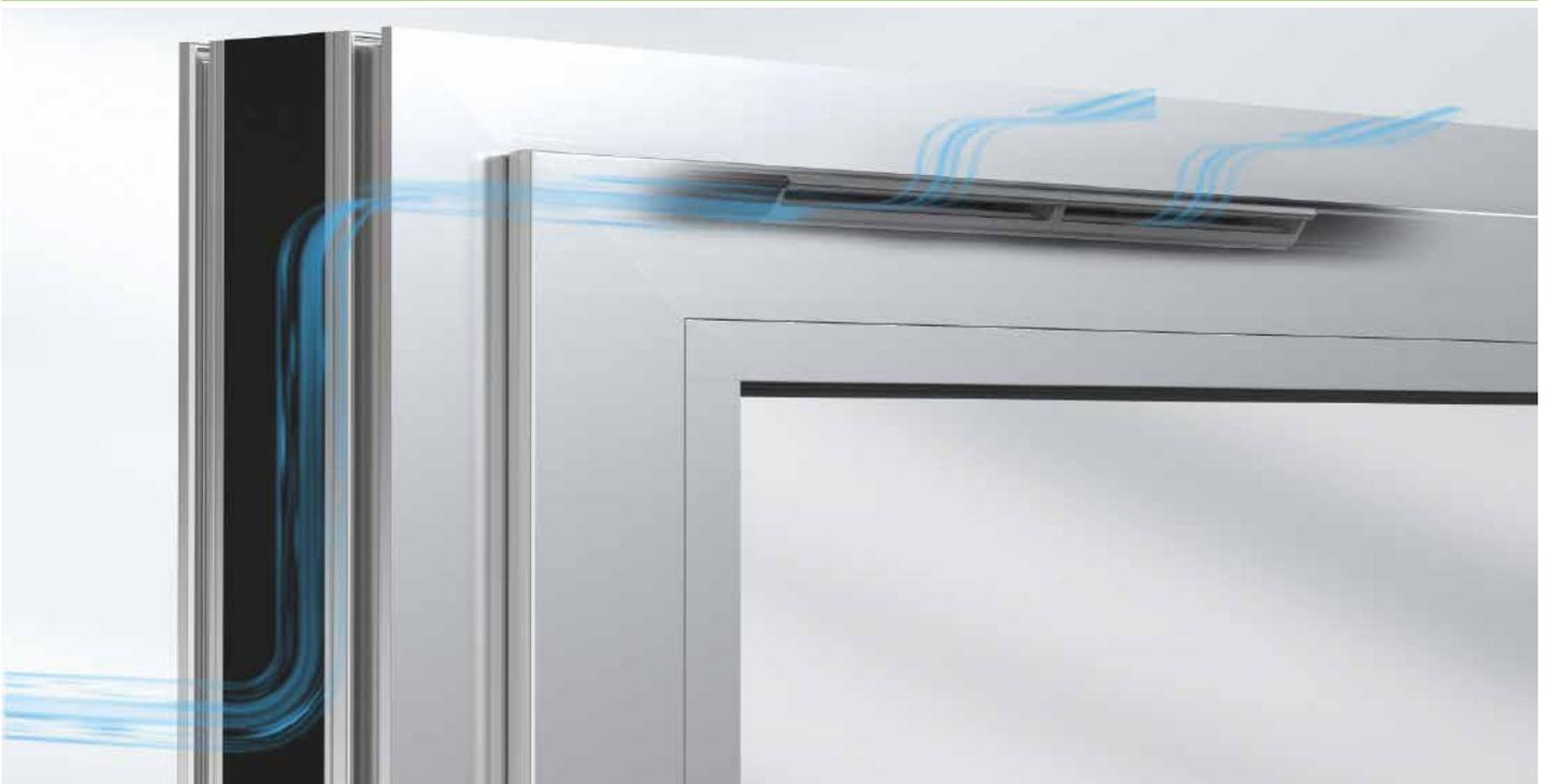
Schüco VentoAir без участия пользователя регулирует вентиляцию и отвод влаги в жилых зданиях, позволяя избежать образования плесени, вредной для здоровья людей и строительных конструкций. Принцип работы основан на компенсации разности давления внутри и вне помещения. При этом система работает механически: при сильном ветре заслонка вентилятора автоматически уменьшает поток поступающего воздуха, предотвращая нежелательный сквозняк.
